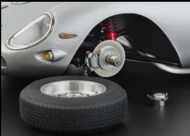
Die Räder sind abnehmbar (3-flügliger Zentralverschluss) und ermöglichen Einsichtnahme auf die Scheibenbremse.
