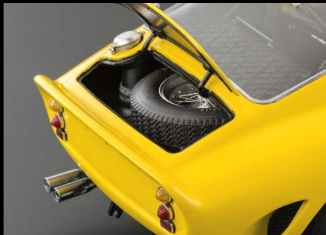
Das Reserverad liegt gut gesichert in einer Aufnahmewanne und ist herausnehmbar.
